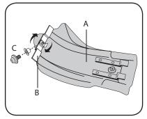
2. Avvitare per due giri la vite alla staffa Screw two turns the screw on the bracket
