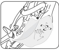
5. Premere il sottomotore e ruotare la staffa di 90°
