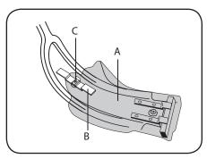
3. Inserire la slitta nel telaio Insert the slide in frame
